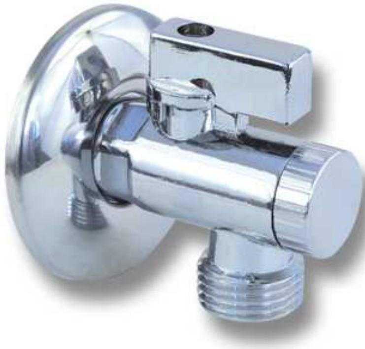
Kuglasti ventil za sanitarije ima glavne komponente od mesinga, ručka je od plastike presvučena Ni-Cr slojem. Dihtovanje je od teflona, O-ring je od gume otporne na radni pritisak i temperaturu.
